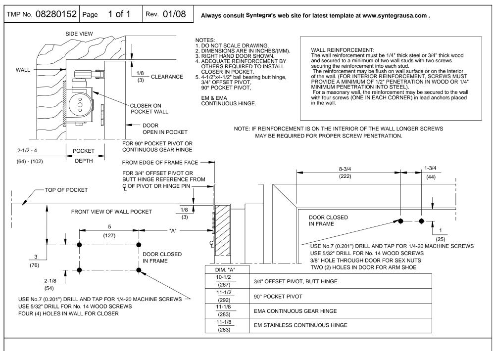
DOOR CLOSER MODELS: CLPKTHD90 90° POCKET INSTALLATION (CLOSER ON WALL)
