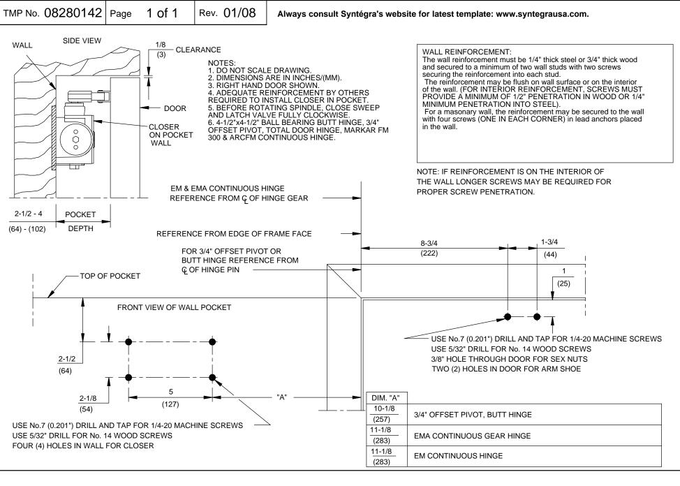
DOOR CLOSER MODELS: CLPKTHD180 POCKET INSTALLATION (CLOSER ON WALL)
